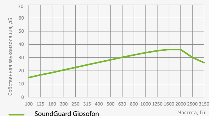
График собственной звукоизоляции воздушного шума Gipsofon (расчетно)
